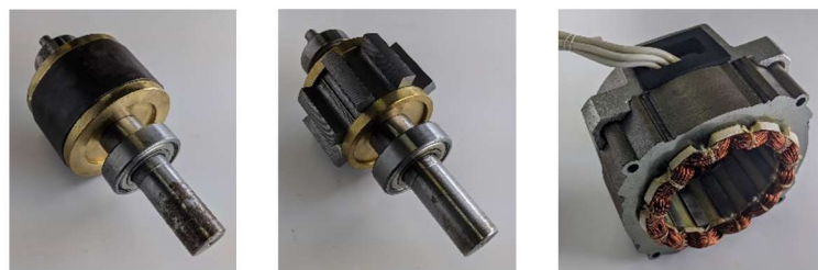
(a) 提案するSRMのロータ (b) 従来のSRMのロータ (c) SRMのステータ
